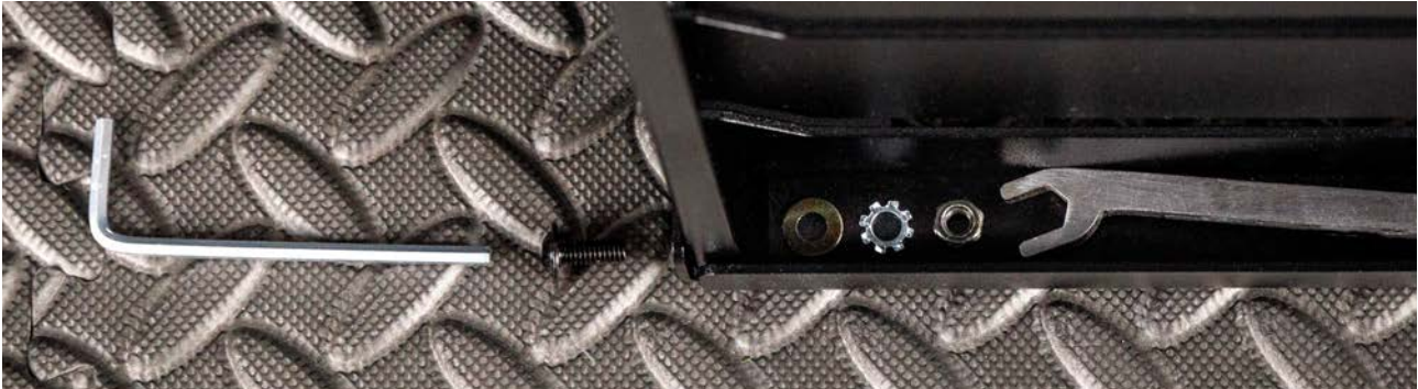
Die richtige Reihenfolge der zu verschraubenden Komponenten
